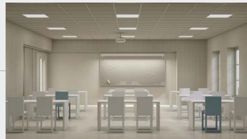
Diminution de l'éclairage sur les postes de travail à 60% et éclairage à 100% du tableau. En éclairant fortement le tableau, on attire l'œil dans cette direction. Le fait de garder suffisamment de lumière sur le plan de travail permet d'éviter les contrastes importants qui seraient à l'origine de fatigue oculaire et d'avoir suffisamment de lumière pour effectuer les tâches appropriées.
